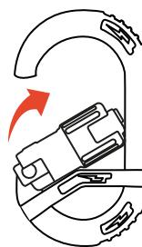
Una vez abierto se puede hacer una conexión con el mosquetón, luego de esto simplemente dejar de ejercer presión sobre el seguro y volverá automáticamente a su posición inicial.
