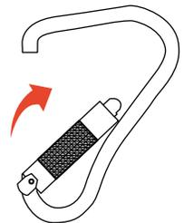
Una vez abierto, se puede hacer conexión con el mosquetón; luego de esto, se deja de ejercer presión sobre el seguro y volverá automáticamente a su posición inicial.
