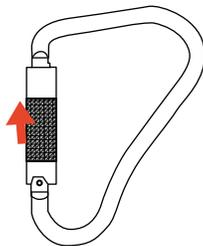
Pulse el sistema de cierre para iniciar el proceso de apertura del mosquetón.
