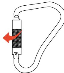
Girar el sistema de la puerta del mosquetón, esta se alineará con un canal que permitirá la apertura del sistema. Luego de haber girado el sistema, mantener la posición y aplicar fuerza con el pulgar hacia el interior del mosquetón.
