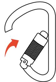
Una vez abierto, se puede hacer conexión con el mosquetón; luego de esto, se deja de ejercer presión sobre el seguro y volverá automáticamente a su posición inicial.
