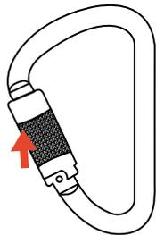
Pulse el sistema de cierre para iniciar el proceso de apertura del mosquetón.
