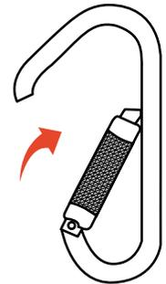
Una vez abierto, se puede hacer conexión con el mosquetón; luego de esto, se deja de ejercer presión sobre el seguro y volverá automáticamente a su posición inicial.
