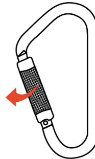
Girar el sistema de la puerta del mosquetón, esta se alineará con un canal que permitirá la apertura del sistema. Luego de haber girado el sistema, mantener la posición y aplicar fuerza con el pulgar hacia el interior del mosquetón.
