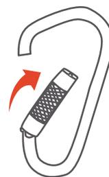
Una vez abierto, se puede hacer conexión con el mosquetón; luego de esto, se deja de ejercer presión sobre el seguro y volverá automáticamente a su posición inicial.
