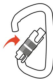
Girar el sistema de la puerta del mosquetón, esta se alineará con un canal que permitirá la apertura del sistema. Luego de haber girado el sistema, mantener la posición y aplicar fuerza con el pulgar hacia el interior del mosquetón.
