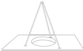
2. La superficie de montaje sobre la que se rige el trípode debe cumplir con las resistencias mínimas de carga estática de al menos 2200 lbs (10 kN) para el personal de rescate y rescate.
