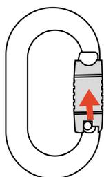
Pulse el sistema de cierre para iniciar el proceso de apertura del mosquetón.
