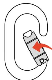
Una vez abierto, se puede hacer conexión con el mosquetón; luego de esto, se deja de ejercer presión sobre el seguro y volverá automáticamente a su posición inicial.
