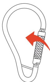
Girar el sistema de la puerta del mosquetón, esta se alineará con un canal que permitirá la apertura del sistema. Luego de haber girado el sistema, mantener la posición y aplicar fuerza con pulgar hacia el interior del mosquetón.
