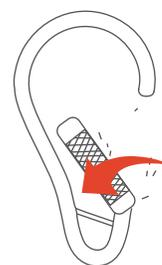
Una vez abierto se puede hacer una conexión con el mosquetón, luego de esto simplemente dejar de ejercer presión sobre el seguro y volverá automáticamente a su posición inicial.
