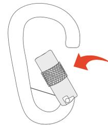
Una vez abierto, se puede hacer conexión con el mosquetón; luego de esto, se deja de ejercer presión sobre el seguro y volverá automáticamente a su posición inicial.
