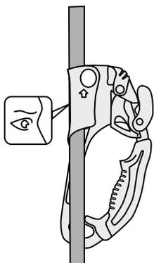
2. Introducir la cuerda en el asa para pulsar el gatillo hacia abajo como se observa en el diagrama.
