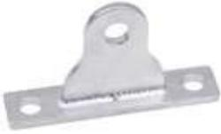
Diseñada para ser instalada en ambos extremos de la línea de vida horizontal, siendo el punto de inicio y fin de la misma. Estas placas van unidas con pernos a la superficie: hormigón, concreto, estructuras metálicas o bastones de anclaje.
