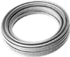
Cable de acero galvanizado con 6 torones de 19 alambres, ofrece resistencia y flexibilidad. Se utiliza en sistemas de protección permanente en altura o líneas de vida.
