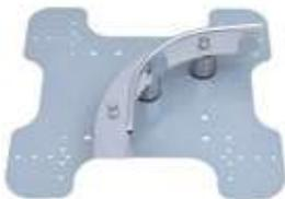
Anclaje curvo para línea de vida horizontal. Permite giro de 90° del cable manteniendo continuidad de la línea de vida. Puede o no utilizarse dependiendo de las necesidades de la línea en particular.
