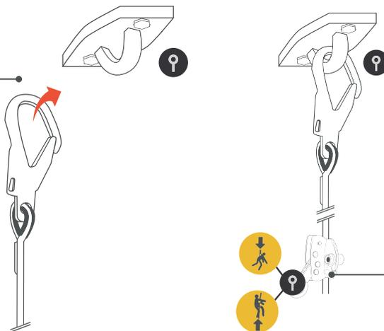
Para los usuarios, conectar un deslizador adecuado al diámetro de la cuerda, asegurar la conexión al arnés y proceder al descenso recorriendo la línea de vida.
