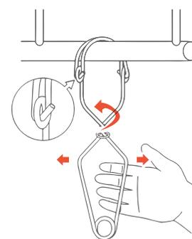
Afloja la presión de la mano y gira el anclaje. Asegúrate de que el anclaje se ha cerrado del todo e instalado correctamente.
