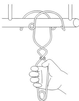
Aprieta la pieza hasta que se abra lo suficiente. Instala el anclaje en su lugar.
