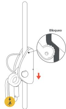
3. La activación de este dispositivo es por basculación, si se le aplica fuerza en contra de su dirección natural, este gatillará su sistema comprimiendo la cuerda y evitando su paso a través de la línea, permitiendo la detención del usuario.
