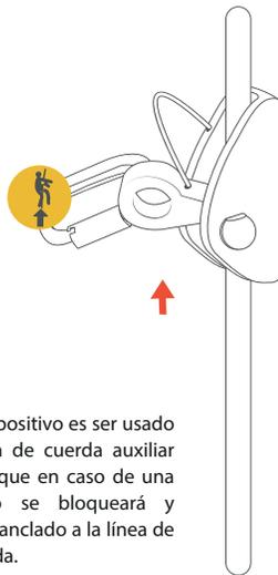
2. El propósito del dispositivo es ser usado en una línea de vida de cuerda auxiliar como protección, ya que en caso de una caída el dispositivo se bloqueará y mantendrá al usuario anclado a la línea de vida evitando una caída.
