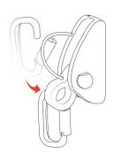
1. Siempre utilizar este tipo de equipos bloqueadores con un conector para hacer el enganche del equipo al usuario.
