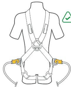
Asegurar ambos conectores del estrobo a las argollas de posicionamiento del arnés o cinturón (argollas laterales ubicadas al nivel de la cintura).
