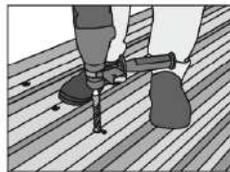
2. Usando una broca tipo corona, realice la perforación a través del recubrimiento existente hasta pasar la viga cubierta.
