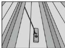
1. Ubique la posición deseada sobre la techumbre y remueva el tornillo o perno existente.
