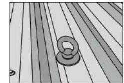
6. Apriete el cáncamo con una barra hasta comprimir el sello superior y la placa inferior, asegurando que el ensamblaje deje de girar para lograr una compresión óptima.
