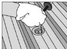
4. Utilice el perno incluido para atornillarlo a la placa metálica del anclaje.
