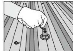
3. Inserte la placa metálica en la perforación, colóquela horizontalmente y use una cuerda pequeña para evitar que caiga.
