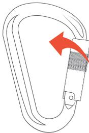
Girar el sistema de la puerta del mosquetón, esta se alineará con un canal que permitirá la apertura del sistema. Luego de haber girado el sistema, mantener la posición y aplicar fuerza con pulgar hacia el interior del mosquetón.
