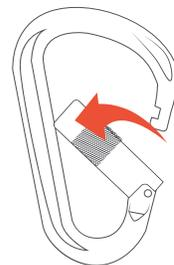
Una vez abierto se puede hacer una conexión con el mosquetón, luego de esto simplemente dejar de ejercer presión sobre el seguro y volverá automáticamente a su posición inicial.
