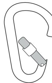
Una vez abierto se puede hacer una conexión con el mosquetón, luego de esto simplemente dejar de ejercer presión sobre el seguro y volverá automáticamente a su posición inicial.
