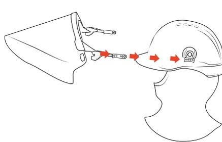
Encajar el visor y soporte para visor en el adaptador para casco y orejera.
