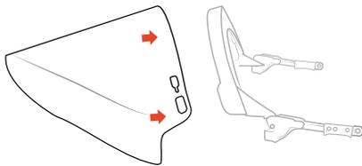
Tomar el visor protector y mediante sus ranuras, conectar al soporte para visor.
