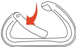
Una vez abierto se puede hacer una conexión con el mosquetón, luego de esto simplemente dejar de ejercer presión sobre el seguro y volverá automáticamente a su posición inicial.
