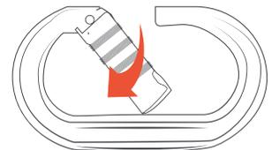
Una vez abierto se puede hacer una conexión con el mosquetón, luego de esto simplemente dejar de ejercer presión sobre el seguro y volverá automáticamente a su posición inicial.
