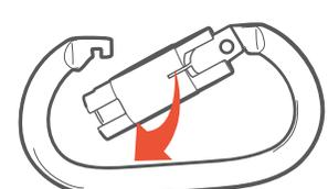
Una vez abierto se puede hacer una conexión con el mosquetón, luego de esto simplemente dejar de ejercer presión sobre el seguro y volverá automáticamente a su posición inicial.
