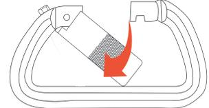
Una vez abierto se puede hacer una conexión con el mosquetón, luego de esto simplemente dejar de ejercer presión sobre el seguro y volverá automáticamente a su posición inicial.
