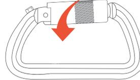
Girar el sistema de la puerta del mosquetón, esta se alinearé con un canal que permitiría la apertura del sistema. Luego de haber girado el sistema mantener la posición y aplicar fuerza con el pulgar hacia el interior del mosquetón.
