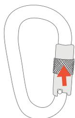
Pulse el sistema de cierre para iniciar el proceso de apertura del mosquetón.
