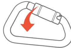
Girar el sistema de la puerta del mosquetón, esta se alineará con un canal que permitiría la apertura del sistema. Luego de haber girado el sistema mantener la posición y aplicar fuerza con el pulgar hacia el interior del mosquetón.
