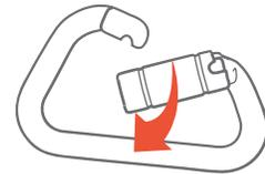
Una vez abierto se puede hacer una conexión con el mosquetón, luego de esto simplemente dejar de ejercer presión sobre el seguro y volverá automáticamente a su posición inicial.
