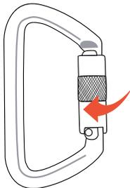
Girar levemente el sistema de la puerta del mosquetón, este se alineará con un canal que permitirá la apertura del mosquetón
