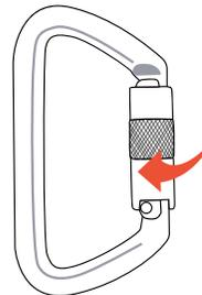
Girar el sistema de la puerta del mosquetón, este se alineará con un canal que permitirá la apertura del sistema. Luego de haber girado el sistema, mantener la posición y aplicar fuerza con el pulgar hacia el interior del mosquetón.
