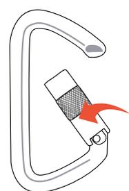
Una vez abierto, se puede hacer conexión con el mosquetón; luego de esto, se deja de ejercer presión sobre el seguro y volverá automáticamente a su posición inicial.
