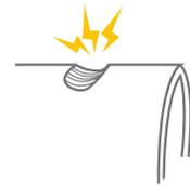
Revisar superficies para daños físicos como quemaduras de cuerda por fricción, cortes o aberturas en el material, en caso de encontrar, dejar el uso del equipo inmediatamente.
