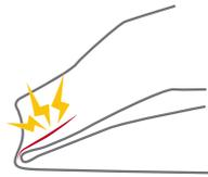
Almacenar guantes siempre de manera estirada, ya que dobleces pueden causar que el material se rompa, provocando que el guante no cumpla su función aislante.
