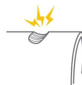
Revisar superficies para daños físicos como quemaduras de cuerda por fricción, cortes o aberturas en el material, en caso de encontrar, dejar el uso del equipo inmediatamente.
