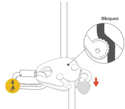
La activación de este dispositivo es por basculación. Si se le aplica fuerza en contra de su dirección natural, este gatillará su sistema comprimiendo la cuerda y evitando su paso a través de la línea, permitiendo la detención del usuario.
