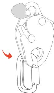
Siempre utilizar este tipo de equipos bloqueadores con un conector para hacer el enganche del equipo hacia el usuario.
