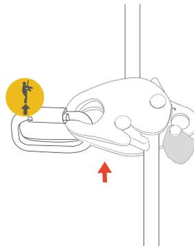
El propósito del dispositivo es ser usado en una línea de cuerda auxiliar al usuario, ello como protección, ya que en caso de una caída, el dispositivo se bloqueará y mantendrá al usuario anclado a la línea auxiliar evitando una caída.
