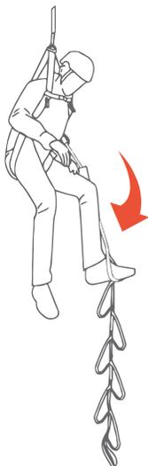
Dispositivo para ser utilizado en situaciones de suspensión por caídas, este se desempaca de su estuche y se despliega automáticamente, de acuerdo a la altura del usuario seleccionar un peldaño donde pueda apoyar el pie para liberar presión en las cintas pelvicas. Uso Aproximado por pierna 5 min.
