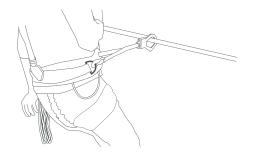
Conexión para posiciónamiento en andamios y estructuras.
