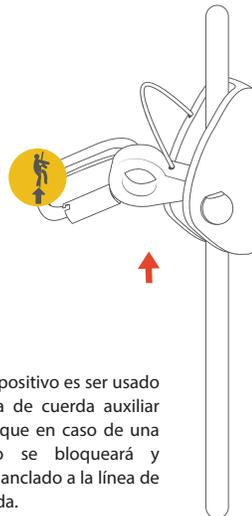
2. El propósito del dispositivo es ser usado en una línea de vida de cuerda auxiliar como protección, ya que en caso de una caída el dispositivo se bloqueará y mantendrá al usuario anclado a la línea de vida evitando una caída.
