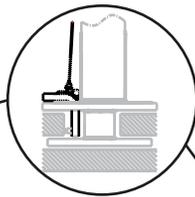
Equipo de fácil instalación como punto de anclaje en containers, este funciona como punto de anclaje o poste de paso para línea de vida.
